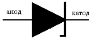
Рис. 50. Условное обозначение стабилитрона
