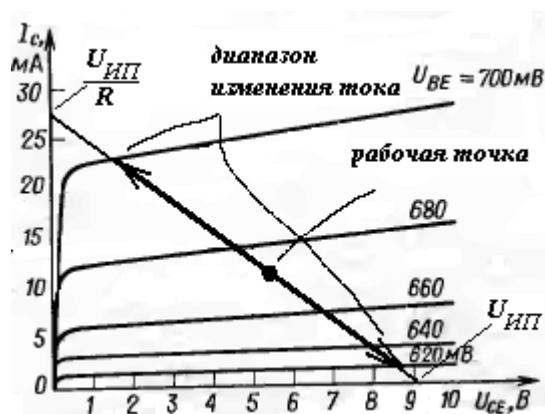
Рис. 43. Построение нагрузочной прямой
