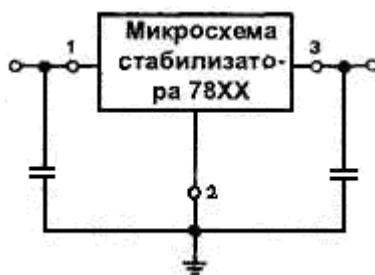
Рис. 61. Схема включения стабилизатора в интегральном исполнении
