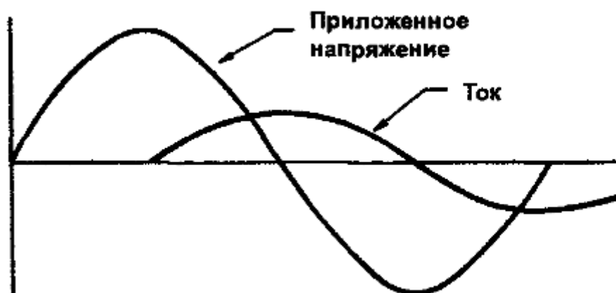
Рис. 23. Переменное напряжение и ток на катушке индуктивности
