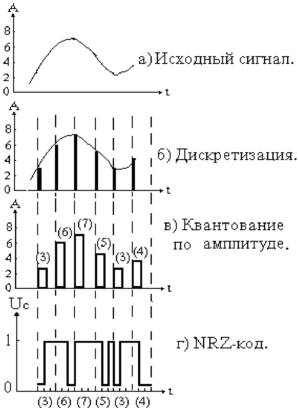
Рис.6. Основные этапы по преобразованию аналогового сигнала в цифровой.
