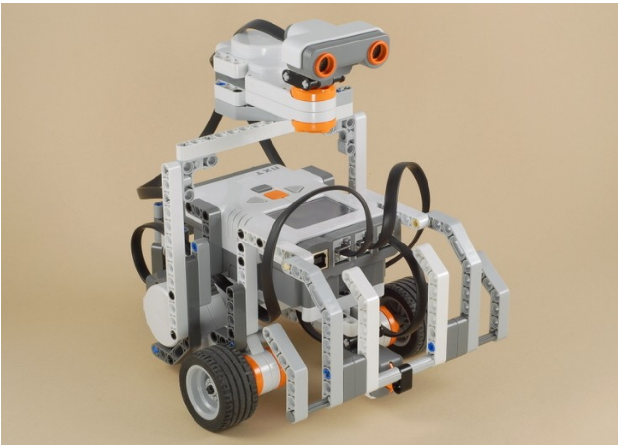
Рис. 11. Мобильный робот с бампером и ультразвуковым датчиком расстояния.
